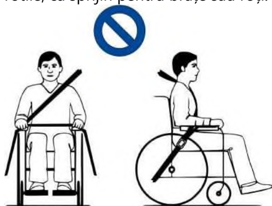
Figura 3 – Potrivire necorespunzătoare a centurii de siguranță
